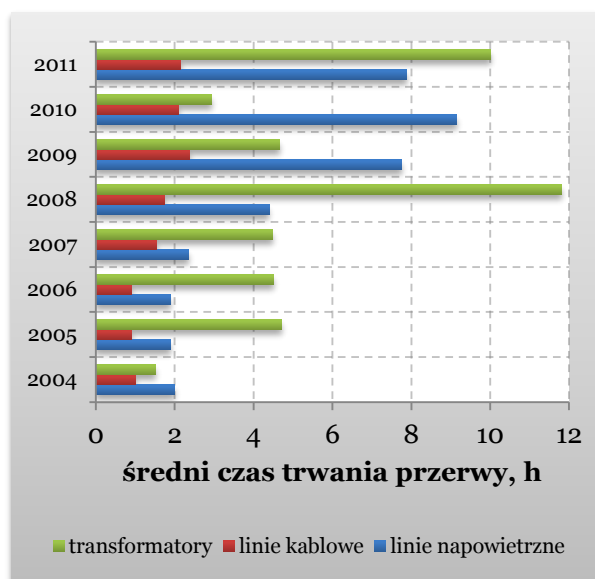
Rys. 17. Średni czas przerwy w dostawie energii elektrycznej z powodu awarii sieci SN
