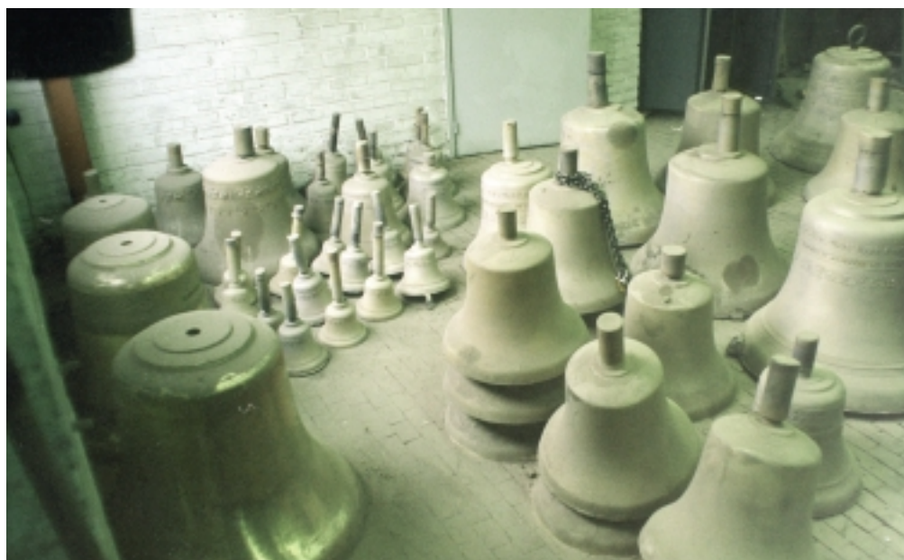
Dzwony gdańskiego carillonu po wyjęciu z form czekają na wyczyszczenie
